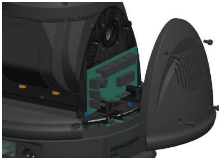
Figura 12. Extracción de las tapas del eje Y para su limpieza
